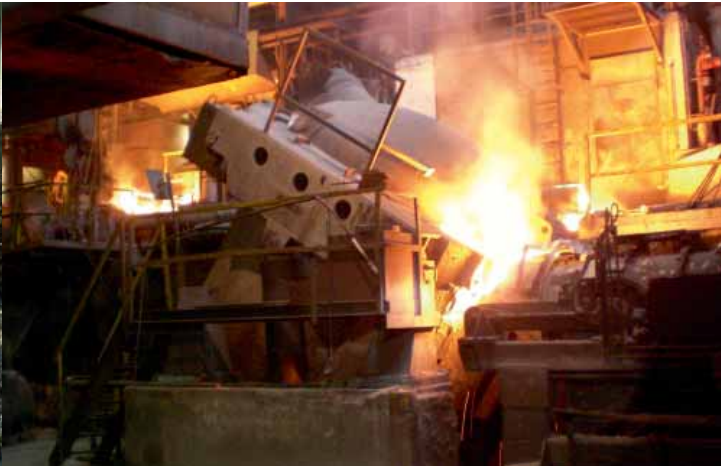
Výroba pilot z litého železa odstředivým litím
