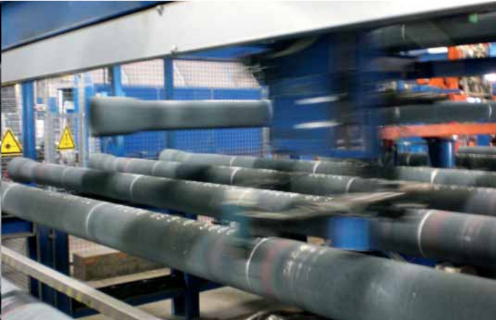
Průběžná kontrola kvality každé jednotlivé pilotové trouby
