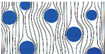
Průběh napěťových křivek u litiny s lamelovým grafitem (vlevo) a kuličkovým grafitem (vpravo)
